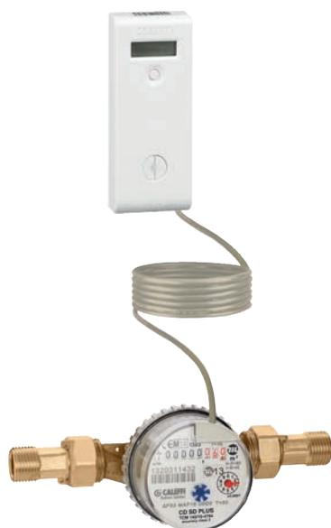
**MONITOR 2.0 PULSE** sono gli acquisitori di impulsi che abbinati ad un contatore d'acqua calda e/o fredda sanitaria dotati di sistemi lancia impulsi, permettono la rilevazione dei consumi d'acqua sanitaria per la contabilizzazione delle spese per singolo alloggio. I dati di consumo sono raccolti via radio ed elaborati direttamente dall'amministratore/gestore attraverso dei report generati dallo stesso software dei ripartitori MONITOR 2.0 / 2.0 E che permette di gestire entrambi i dispositivi.
